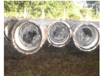
Dutos inutilizados por deposição severa de parafina (Petrobrás)
