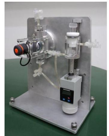
À direita: micromanômetro especialmente projetado para medições de diferencial de pressão no experimento de redução de arraste com riblets.
