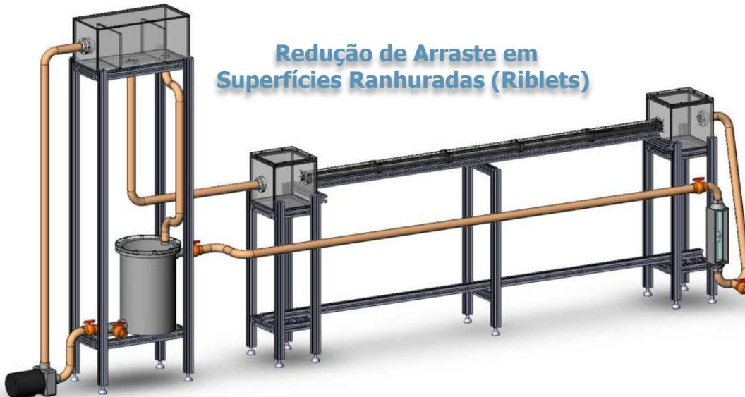
À esquerda: circuito montado para experimento de redução de arraste com superfície ranhurada. A seção reta do canal é quadrada, e “riblets” são usinados nas paredes inferior e superior do canal somente na região de escoamento desenvolvido.
