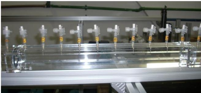
À esquerda: detalhe das tomadas de pressão, distribuídas ao longo de todo o canal.
