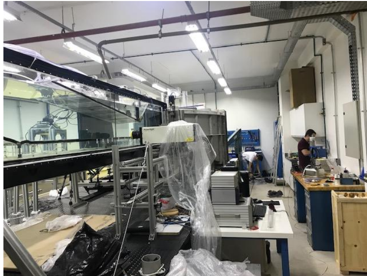
Figura 2: Seção de testes transparente do canal de água instalada no laboratório do subsolo, mostrando equipamento de medição de velocidade laser-Doppler.
