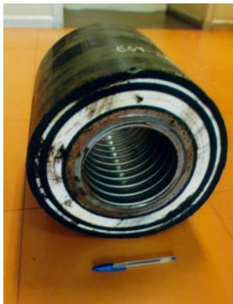
Figura 2 – Amostra de linha submarina de petróleo isolada termicamente.
