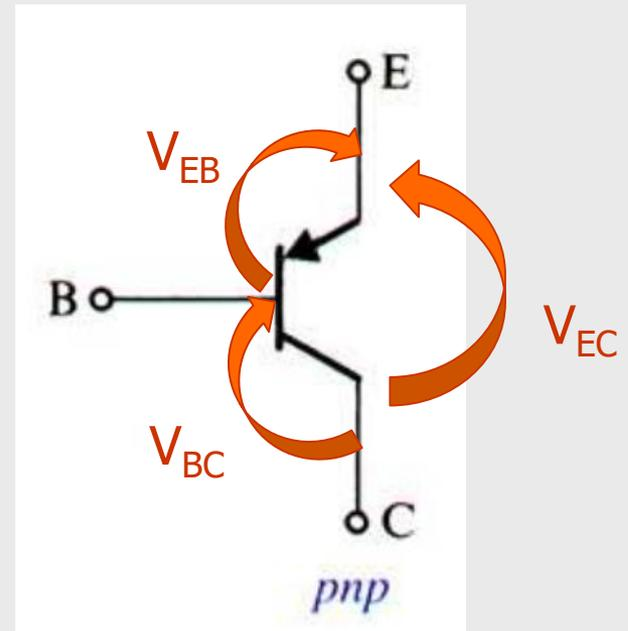
$$V_{EC} = V_{EB} + V_{BC}$$
