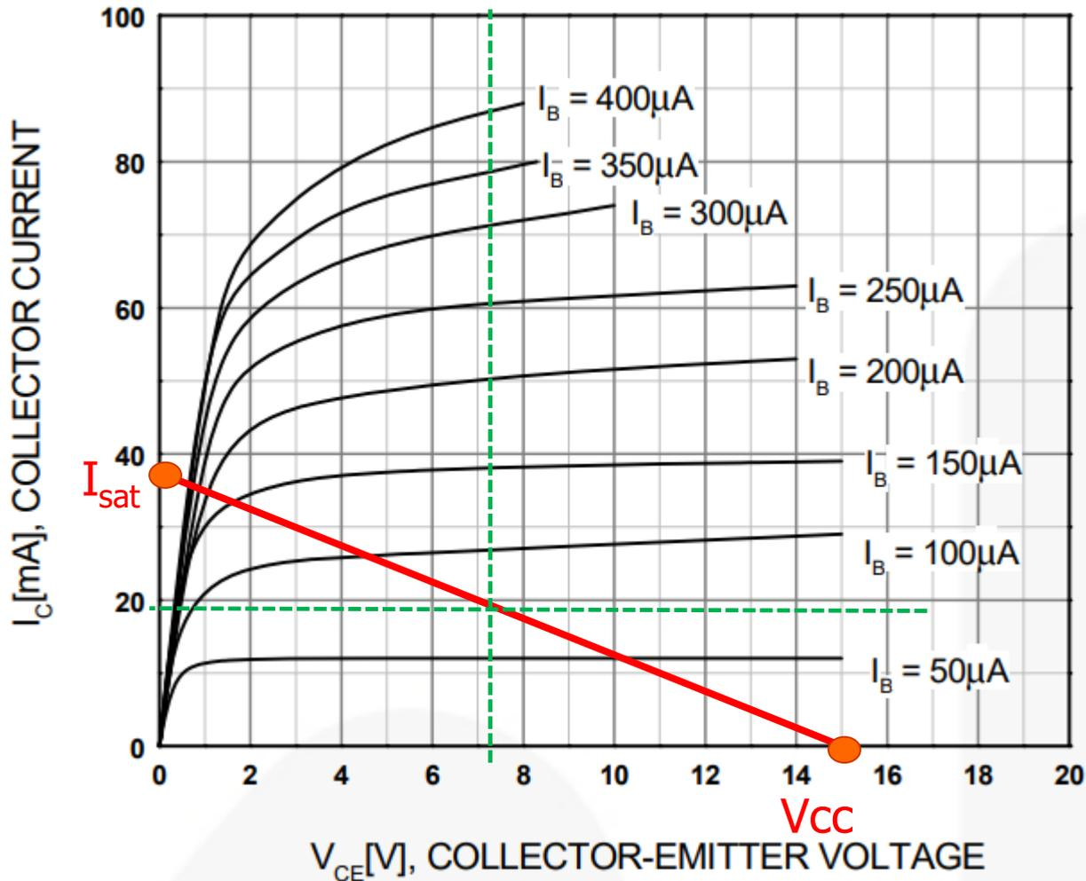
Ponto de operação é um dos pontos da curva de carga!
